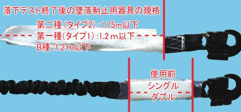
落下テスト終了後の墜落制止用器具の規格
