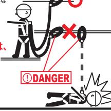
※墜落制止器具の使用可能質量は、着用者の体重およびその装備品の質量の合計100kg以下とする。
